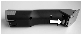
Fig. 6 Engate da cabeça de tosquia
