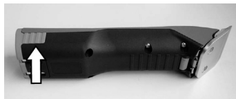
Fig. 7 Engate da bateria
