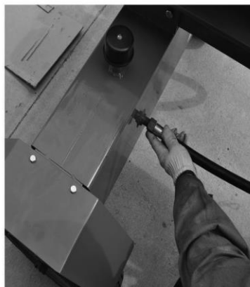
17. Conecte el otro tubo negro de aceite en el depósito de aceite
