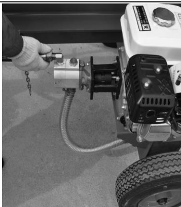
16. Conecte el tubo de color negro en la bomba de aceite y en el filtro de aceite del depósito
