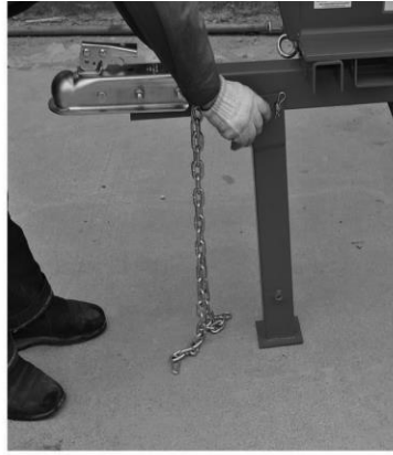
11. Mantenga la máquina nivelado con la mano y coloque el descanso frontal
