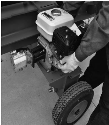
13. Coloque el motor (con aceite) en la posición correcta, en el apoyo de la máquina
