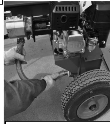
15. Conecte el tubo de color blanco entre la bomba de aceite y el filtro de aceite del depósito y apriete bien la puerca
