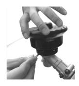
**Solte a cabeça de corte de nylon.** Utilize uma chave de fenda para segurar a braçadeira e logo gire a cabeça de corte de nylon no sentido das agulhas do relógio até que esteja bem fixa, será substituída.
