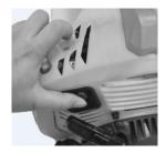
2. Ajuste a alavanca do arrancador à posição (off).
