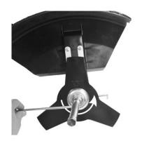
**Libere a lâmina.** Utilize uma chave de fenda para segurar a braçadeira e a porca de liberação, a lâmina pode descolar-se.
