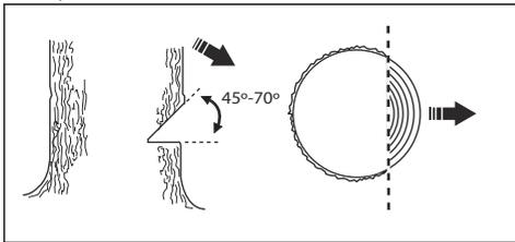
a) Haga el corte de indicación superior. Alinee la marca de dirección de derribo (1) del producto con la dirección de derribo del árbol (2). Sitúese detrás del producto y mantenga el árbol a su izquierda. Efectúe un corte con cadena tirante.
