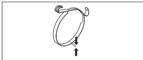
2. Realice una comprobación de la cinta de freno. La cinta de freno debe tener un mínimo de 0,6 mm (0,024 pulg) de espesor en el punto más desgastado.
