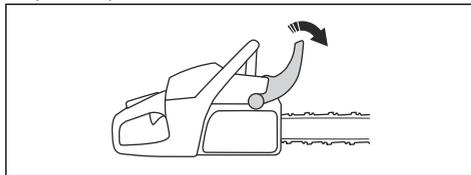
2. Tire del interruptor de arranque/parada (1) hacia afuera y hacia arriba para colocarlo en la posición de estrangulamiento.
