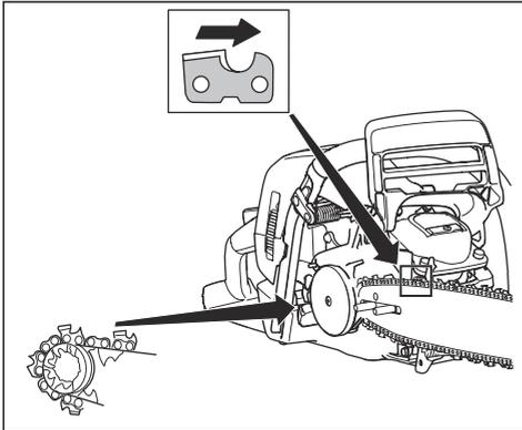
6. Alinee el orificio de la espada con el pasador de ajuste de la cadena e instale la cubierta del embrague.
