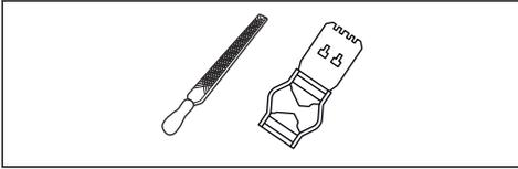
1. Utilice una lima plana y un calibrador de profundidad para ajustar el calibre de profundidad. Utilice solamente el calibrador de profundidad Husqvarna para obtener el ajuste de calibre de profundidad y el ángulo del calibre de profundidad adecuados.
