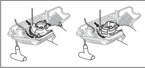
5. 545 Mark II, 545G Mark II: Retire el tornillo central (A), el manguito (B) y el muelle (C).
