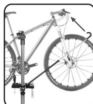
Varilla metálica ajustable para fijación del manillar
