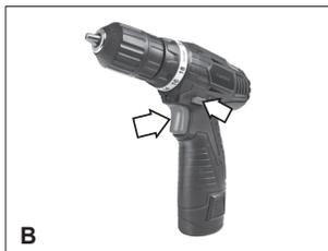
Presiónelo para accionar su taladro y suéltelo para detenerlo. El interruptor de encendido/apagado posee un dispositivo de frenado que detiene el mandril de forma inmediata cuando Ud. suelta rápidamente el interruptor. También es un conmutador de velocidad variable que ofrece mayor velocidad y torsión al aumentar la presión del gatillo. La velocidad se
