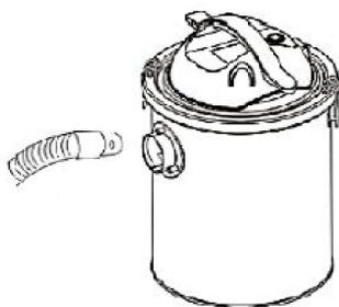
Inserte el mango en el tubo y gire para hacer coincidir el encaje.
