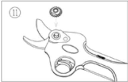
11. Place gear nut on center bolt.
