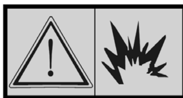
Risco de inflamação quando é realizado o reabastecimento de combustível
