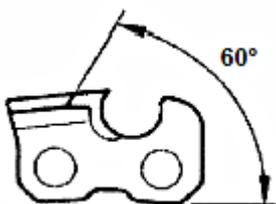
5. El ángulo de entrada de afilado se verá reducido en cada afilado. Para asegurar un buen nivel de corte, el elemento de medida de profundidad tendrá que ser rebajado también. La guía de profundidad deberá estar, respecto del tope de altura del diente de corte, aproximadamente
