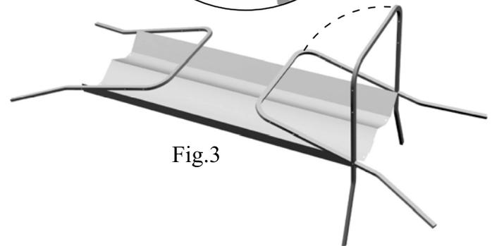
1º.- Colocar las patas (2) abatiéndolas sobre la bandeja y poner los tornillos (6) con arandelas en los taladros inferiores de las patas.
