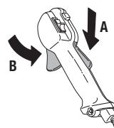
Compruebe que el acelerador esté bloqueado en la posición de ralentí cuando el fiador está en su posición inicial.
