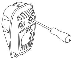
Se a sua máquina estiver equipada com um abafachamas, este deverá ser submetido a uma limpeza periódica. A rede obstruída leva a um aquecimento que pode acarretar sérios danos para o motor.
