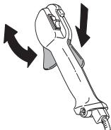
Consulte las instrucciones bajo el título Arranque. Ponga en marcha la máquina y acelere al máximo. Suelte el acelerador y controle que el equipo de corte se detenga y permanezca inmóvil. Si el equipo de corte gira con el acelerador en ralentí, se debe controlar la regulación del carburador para ralentí. Consulte las instrucciones bajo el título Mantenimiento.
