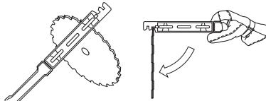
Verifique se o equipamento de corte está danificado ou com rachaduras. Um equipamento de corte danificado deve sempre ser substituído.
