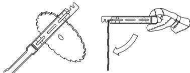
Revise el equipo de corte para ver si está dañado o agrietado. Un equipo de corte dañado debe ser siempre reemplazado.
