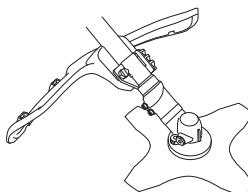
Verifique se a protecção está em bom estado e sem rachaduras. Troque a protecção se esta foi sujeita a golpes ou se tem rachaduras.
