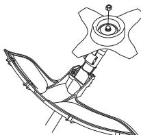
Para el montaje, apriete la tuerca girándola en sentido contrario al sentido de rotación del equipo de corte. Para el desmontaje, afloje la tuerca girándola en el sentido de rotación del equipo de corte. (NOTA: La tuerca tiene rosca a izquierdas.) Apriete la tuerca con la llave para tuerca de la hoja.
