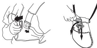
Verifique se as correias do suporte estão correctamente posicionadas. Quando o suporte e a máquina estão ajustados, verifique se o desengate de emergência do suporte funciona.
