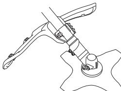
Controle que la protección no esté dañada y que no tenga grietas. Cambie la protección si ha estado expuesta a golpes o si tiene grietas.
