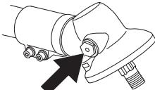
Generalmente, el lubricante en el cuerpo del engranaje no requiere cambiarse excepto cuando se realizan reparaciones.
