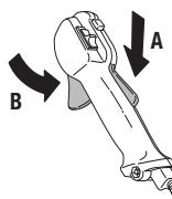
Verifique se o acelerador está fixo na posição marcha em vazio quando o bloqueio de acelerador estiver na sua posição original.
