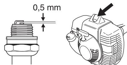
**NOTA!** Use sempre o tipo de vela de ignição recomendado! Uma vela de ignição incorrecta pode danificar o pistão/cilindro.
