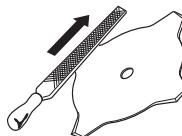
Mantenha o correcto travamento dos dentes da serra! Siga as nossas instruções e use a ferramenta de travamento recomendada. Uma lâmina de serra com o denteado incorrectamente travado aumenta o risco de bloqueio e arremesso, bem como de danos na lâmina da serra.
