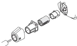
Verifique periodicamente os elementos anti-vibração quanto a rachaduras no material e deformações.
