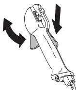
Veja instruções na secção Arranque. Arranque com a máquina e acelere a fundo. Solte o acelerador e verifique se o equipamento de corte pára e permanece imóvel. Se o equipamento de corte girar com o acelerador na marcha em vazio, controle o ajuste da marcha em vazio do carburador. Ver instruções no capítulo Manutenção.
