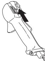
**NOTA!** O contacto de paragem retorna automaticamente à posição de arranque. Por isso, para impedir o arranque acidental da máquina, deve-se sempre remover a protecção da vela de ignição durante todos os trabalhos de montagem, inspecção e/ou manutenção.
