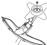
Ao montar, aperte a porca no sentido oposto ao sentido de rotação do equipamento de corte. Para desmontar, desaperte a porca no sentido da rotação do equipamento de corte. (NOTA! A porca tem rosca à esquerda.) Aperte a porca com a chave de aperto da porca do disco.
