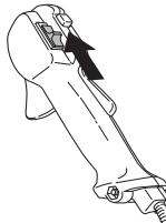
**¡NOTA!** El contacto de parada retorna automáticamente a la posición de arranque. Por consiguiente, antes de realizar trabajos de montaje, control y/o mantenimiento se debe quitar el capuchón de encendido de la bujía para evitar el arranque imprevisto.
