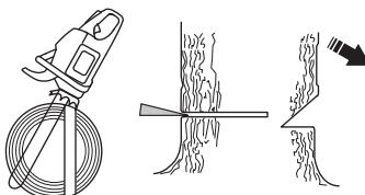
O corte de abate deverá terminar paralelamente à linha de corte direccional de modo que a distância entre ambos seja no mínimo de 1/10 do diâmetro do tronco. A parte não serrada no tronco é designada de linha de ruptura. A linha de ruptura funciona como uma dobradiça que comanda a direcção da queda da árvore.
