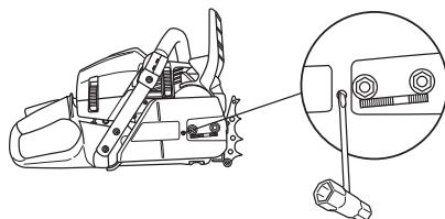
La cadena está correctamente tensada cuando no cuelga en la parte inferior de la espada y puede girarse fácilmente con la mano. Apriete las tuercas de la espada con la llave combinada, sujetando al mismo tiempo la punta de la espada.
