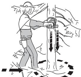
Remova a vegetação do solo em volta da árvore e prepare-se para eventuais obstáculos (pedras, galhos, buracos, etc.) de modo que possa fugir facilmente quando a árvore começar a cair. O caminho de fuga deve estar situada a cerca de 135° diagonalmente para trás da direcção de abate planeada para árvore.
