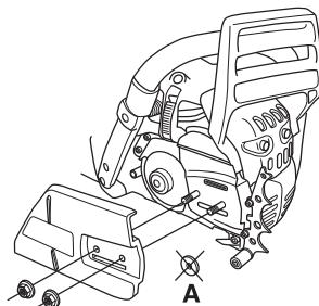
Monte la espada en los pernos. Sitúela en la posición posterior extrema. Monte la cadena en el piñón de arrastre y la guía de la espada. Empiece con la parte superior de la cadena.
