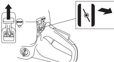
**Aceleração de arranque:** A posição combinada estrangulador/aceleração de arranque obtém-se ao colocar o comando na posição de estrangular.
