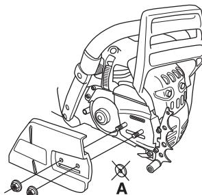
Monte a lâmina nos seus parafusos. Coloque a lâmina na sua posição mais atrás. Ponha a corrente sobre o pinhão e a ranhura da lâmina. Comece pela parte superior da lâmina.
