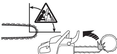
Serrar com a parte inferior da lâmina, ou seja, serrar a partir do lado superior do objecto a ser serrado, e para baixo, chama-se serrar com a corrente a puxar. Então a moto-serra é puxada contra a árvore e o canto anterior do corpo da moto-serra forma um apoio natural contra o tronco. Serração com a corrente a puxar possibilita ao utilizador um melhor controlo sobre a moto-serra bem como sobre onde o sector de risco de retrocesso da lâmina está localizado.
