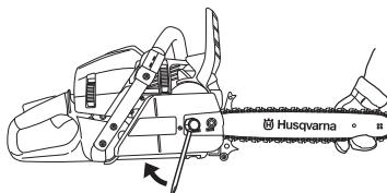
Numa corrente nova, a tensão deverá ser controlada constantemente até concluir a rodagem. Verifique a tensão da corrente regularmente. Uma corrente correcta significa boa capacidade de corte e longa vida útil.
