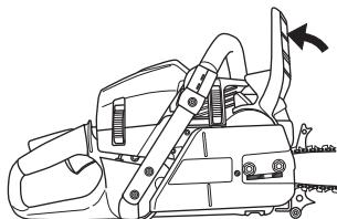
Desenrosque las tuercas de la espada y saque la cubierta del embrague (el freno de cadena). Saque la protección de transporte (A).
