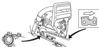
Compruebe que los filos de los eslabones de corte estén orientados hacia delante en la parte superior de la espada.
