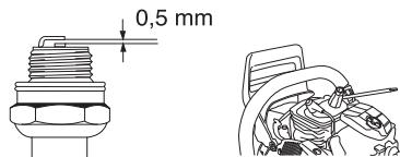
Observe! Use sempre o tipo de vela de ignição recomendado! Uma vela de ignição incorrecta pode danificar o pistão/cilindro. Verifique se a vela de ignição não produz interferências de rádio.
