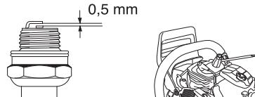
Aclaración! ¡Utilice siempre el tipo de bujía recomendado! Una bujía incorrecta puede arruinar el pistón y el cilindro. Asegúrese de que la bujía tenga supresión de perturbaciones radioeléctricas.
