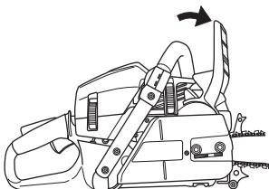
**Ignição; estrangulador:** Ponha o estrangulador na posição de estrangular. O contacto de paragem irá automaticamente para a posição de arranque.
