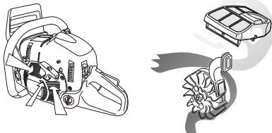
**IMPORTANTE!** Para conservar a função de purificação centrífuga, é necessário prestar assistência e manutenção contínuas. Limpe a entrada de ar do dispositivo de arranque, asas de ventoinha da cambota, compartimento em torno da cambota, tubo de admissão e o compartimento do carburador.
