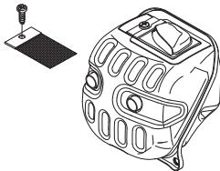
El silenciador está diseñado para amortiguar el ruido y para apartar del usuario los gases de escape. Los gases de escape están calientes y pueden contener chispas que pueden ocasionar incendios si se dirigen los gases a materiales secos e inflamables.
