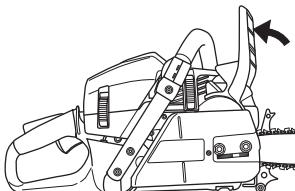
Desatarraxe inteiramente as porcas e remova a cobertura de acoplamento (travão de corrente). Retire o protector para transporte (A).
