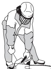
Comprima imediatamente para dentro o estrangulador quando o motor funcionar e faça renovadas tentativas até que o motor arranque. Quando o motor arrancar dê rapidamente aceleração total e a aceleração de arranque é automaticamente desligada.
