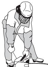
Cuando el motor encienda, oprima inmediatamente el estrangulador y repita los intentos de arranque hasta que el motor se ponga en marcha. Cuando arranque el motor,
