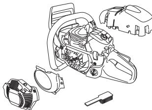
Limpe o sistema de arrefecimento com uma escova, uma vez por semana, ou com mais frequência, em condições de trabalho difíceis. O sistema de arrefecimento obstruído ou sujo conduz a um sobreaquecimento da máquina, danificando o cilindro e o pistão.
