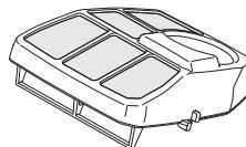
Un filtro utilizado durante mucho tiempo no puede limpiarse del todo. Por tanto, hay que cambiarlo a intervalos regulares. **Un filtro de aire averiado debe cambiarse.**
