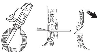
El corte de derribo debe quedar paralelo con la línea de corte de indicación, con una distancia mínima entre ambos de 1/10 del diámetro del tronco. La parte del tronco sin cortar se denomina faja de desgaje.
