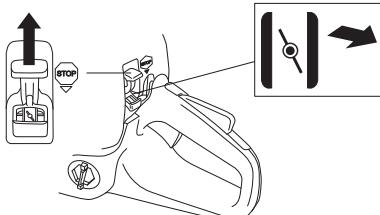
**Aceleración de arranque:** Para la función combinada de estrangulamiento/aceleración de arranque ponga el estrangulador en la posición de estrangulamiento.
