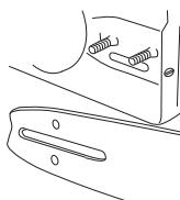
Estique a corrente, apertando com o auxílio da chave universal ou parafuso esticador da corrente, no sentido horário. Estique a corrente até que esta deixe de estar frouxa na parte inferior da lâmina.
