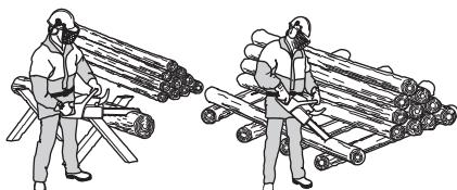
**O tronco está deitado sobre o solo.** Não há nenhum risco da corrente se prender ou de fendilhamento do objecto a serrar. O risco é, entretanto, grande de que a corrente toque o solo após a serração de fora a fora.
