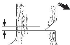
Coloque el apoyo de corteza (si ha sido montado) detrás de la faja de desgaje. Corte con aceleración máxima introduciendo lentamente la cadena/espada en el tronco. Preste atención a si el árbol se mueve en dirección opuesta a la elegida para el derribo. Tan pronto lo permita la profundidad de corte, ponga una cuña de derribo o una barra desgajadora en el corte de derribo.
