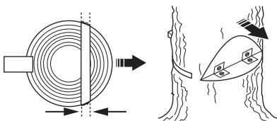
Se pierde completamente el control de la dirección de derribo del árbol si la faja de desgaje es demasiado pequeña o se atraviesa al cortar, o si los cortes de indicación y derribo están mal situados.
