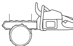
Há métodos para abate de árvores com os diâmetros do tronco maiores do que o comprimento da lâmina. Esses métodos acarretam o grande perigo de que o sector de risco de retrocesso da lâmina entre em contacto com algum objecto.
