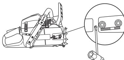
A corrente está correctamente esticada quando não mais estriver frouxa na parte inferior da lâmina e ainda possa ser girada facilmente com a mão. Aperte bem as porcas da lâmina com a chave universal ao mesmo tempo que segura a extremidade da lâmina.
