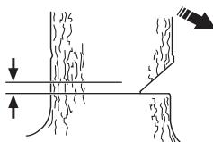
Coloque o apoio para casca (se estiver montado) atrás da linha de ruptura. Serre com aceleração total e deixe a corrente/lâmina penetrar devagar na árvore. Observe se a árvore se move no sentido contrário ao da direcção de queda pretendida. Introduza uma cunha de abate ou barra extractora logo que a profundidade de corte o permita.
