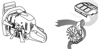
**¡IMPORTANTE!** Para que la depuración centrífuga funcione satisfactoriamente, debe efectuarse un mantenimiento constante del sistema. Limpie la toma de aire del mecanismo de arranque, las palas de ventilador del volante, el espacio alrededor del volante, el tubo de admisión y el compartimento del carburador.
