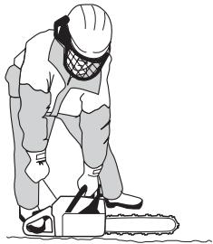
Segure a moto-serra numa posição firme, com os polegares e dedos à volta do punho.
