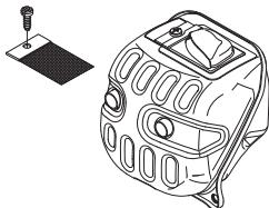
O silenciador é configurado para abafar o nível de ruído e para conduzir os gases de escape para longe do utilizador. Os gases de escape são quentes e podem conter faíscas que podem causar incêndios, se os gases forem dirigidos contra um material seco e inflamável.
