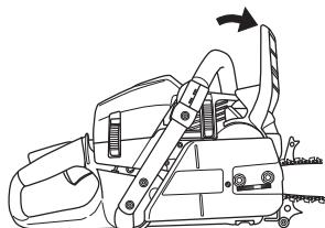
**Encendido; estrangulador:** Ponga el estrangulador en la posición de estrangulamiento. Entonces, el botón de parada se desplazará automáticamente hacia la posición de arranque.
