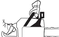
Acelere al máximo y active el freno de cadena girando la muñeca izquierda hacia la protección contra reculadas. No suelte el mango delantero. **La cadena debe detenerse inmediatamente.**
