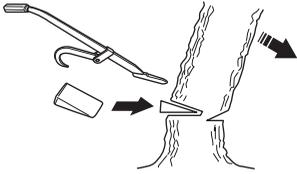
Recomendamos o uso de um comprimento de lâmina superior ao diâmetro do tronco na copa da árvore, de modo que o corte de abate e o corte direccional possam ser executados com o chamado 'corte simples'. Ver o capítulo Especificações técnicas com relação ao comprimento de lâmina adequado ao seu modelo de motosserra.
