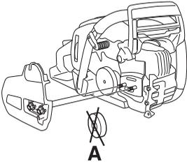
Monte la espada en los pernos. Sitúela en la posición posterior extrema. Monte la cadena en el piñón de arrastre y la guía de la espada. Empiece con la parte superior de la cadena.
