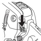
O motor arranca carregando no comando de arranque/paragem.
