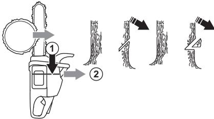
La profundidad del corte de indicación debe ser igual a  $1/4$  del diámetro del tronco, y el ángulo entre los cortes superior e inferior debe ser de  $45^\circ$  como mínimo.
