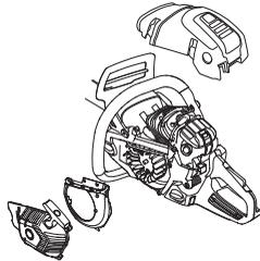
Limpe o sistema de arrefecimento com uma escova, uma vez por semana, ou com mais frequência, em condições de trabalho difíceis. O sistema de arrefecimento obstruído ou sujo conduz a um sobreaquecimento da máquina, danificando o cilindro e o pistão.
