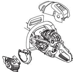
Limpie el sistema refrigerante con un cepillo una vez por semana (en condiciones difíciles, con mayor frecuencia). Un sistema refrigerante sucio u obturado produce sobrecalentamiento de la máquina, con las consiguientes averías del cilindro y el pistón.
