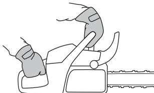
Acelere al máximo y active el freno de cadena girando la muñeca izquierda hacia la protección contra reculadas.
