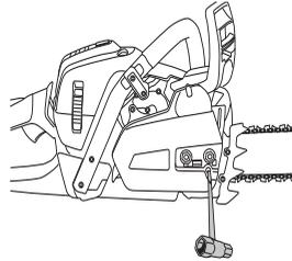
La cadena está correctamente tensada cuando no cuelga en la parte inferior de la espada y puede girarse fácilmente con la mano. Apriete las tuercas de la espada con la llave combinada, sujetando al mismo tiempo la punta de la espada.
