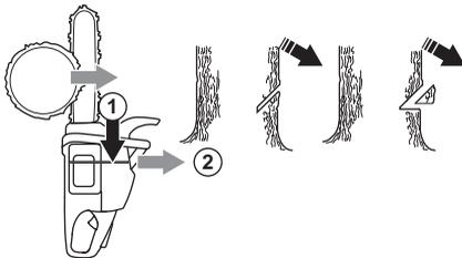
A profundidade do corte direccional deve ser de 1/4 do diâmetro do tronco e o ângulo entre o corte superior e o inferior, no mínimo de 45°.
