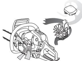
**¡IMPORTANTE!** Para que la depuración centrífuga funcione satisfactoriamente, debe efectuarse un mantenimiento constante del sistema. Limpie la toma de aire del mecanismo de arranque, las palas de ventilador
