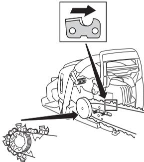
Verifique se o fio dos elos de corte está voltado para a frente, na parte superior da lâmina.
