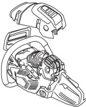
Uma limpeza mais completa obtém-se ao lavar o filtro com água e sabão.
