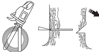
O corte de abate deverá terminar paralelamente à linha de corte direccional de modo que a distância entre ambos seja no mínimo de 1/10 do diâmetro do tronco. A parte não serrada no tronco é designada de linha de ruptura.
