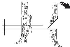
Coloque o apoio para casca (se estiver montado) atrás da linha de ruptura. Serre com aceleração total e deixa a corrente/lâmina penetrar devagar na árvore. Observe se a árvore se move no sentido contrário ao da direcção de queda pretendida. Introduza uma cunha de abate ou barra extractora logo que a profundidade de corte o permita.
