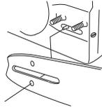
Estique a corrente, apertando com o auxílio da chave universal ou parafuso esticador da corrente, no sentido horário. Estique a corrente até que esta deixe de estar frouxa na parte inferior da lâmina. Ver instruções na secção Esticar a corrente da serra.
