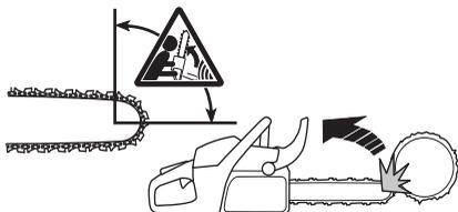
O retrocesso desloca-se sempre na direcção do plano da lâmina. Mais comum é que a moto-serra e a lâmina sejam arremessadas para cima e para trás, contra o utilizador. Entretanto, ocorrem outras direcções de retrocesso, dependendo da posição da moto-serra no momento em que o sector de risco de retrocesso a lâmina entrou em contacto com um objecto.
