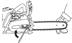
Numa corrente nova, a tensão deverá ser controlada constantemente até concluir a rodagem. Verifique a tensão da corrente regularmente. Uma corrente correcta significa boa capacidade de corte e longa vida útil.
