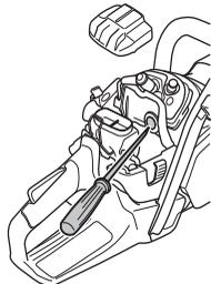
En el caso de temperaturas inferiores a  $-5^{\circ}\text{C}$  y/o con nieve, hay una cubierta especial que se coloca sobre el cuerpo del mecanismo de arranque.
