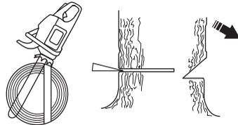
El corte de derribo debe quedar paralelo con la línea de corte de indicación, con una distancia mínima entre ambos de  $1/10$  del diámetro del tronco. La parte del tronco sin cortar se denomina faja de desgaje.
