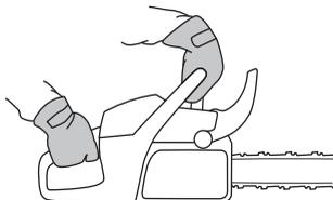
Acelere ao máximo e active o travão de corrente, virando o pulso esquerdo contra a protecção anti-retrocesso. Não solte o punho dianteiro. **A corrente deverá parar imediatamente.**
