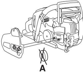
Monte a lâmina nos seus parafusos. Coloque a lâmina na sua posição mais atrás. Ponha a corrente sobre o pinhão e a ranhura da lâmina. Comece pela parte superior da lâmina.
