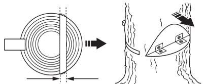
Perde-se todo o controlo sobre a direcção de queda da árvore se a linha de ruptura for demasiado pequena ou
