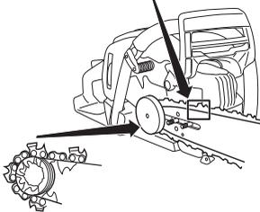
Compruebe que los filos de los eslabones de corte estén orientados hacia delante en la parte superior de la espada.
