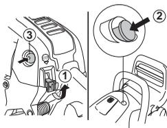
Segure no punho dianteiro com a mão esquerda. Coloque o pé direito na posição da bota através da secção inferior do punho traseiro e pressione a máquina contra o solo.
