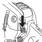
El motor se arranca presionando el mando de arranque/parada.
