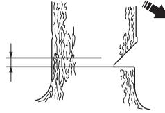
Coloque el apoyo de corteza (si ha sido montado) detrás de la faja de desgaje. Corte con aceleración máxima introduciendo lentamente la cadena/espada en el tronco. Preste atención a si el árbol se mueve en dirección opuesta a la elegida para el derribo. Tan pronto lo permita la profundidad de corte, ponga una cuña de derribo o una barra desgajadora en el corte de derribo.
