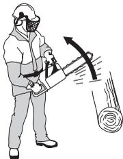
Retrocesso somente pode ocorrer quando o sector de risco de retrocesso da lâmina entrar em contacto com um objecto.
