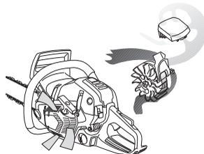
**IMPORTANTE!** Para conservar a função de purificação centrífuga, é necessário prestar assistência e manutenção contínuas. Limpe a entrada de ar do dispositivo de arranque, asas de ventoinha da cambota, compartimento em torno da cambota, tubo de admissão e compartimento do carburador.
