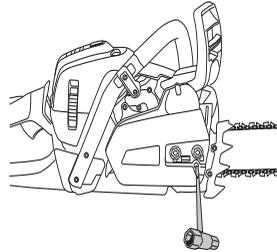
A corrente está correctamente esticada quando não estiver frouxa na parte inferior da lâmina e ainda possa ser girada facilmente com a mão. Aperte bem as porcas da lâmina com a chave universal ao mesmo tempo que segura a extremidade da lâmina.
