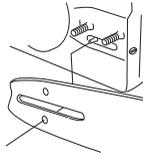
Tense la cadena enroscando en el sentido de las agujas del reloj el tornillo de tensado con la llave combinada. La cadena debe tensarse hasta que deje de colgar en la parte inferior de la espada. Vea las instrucciones del capítulo Tensado de la cadena de sierra.
