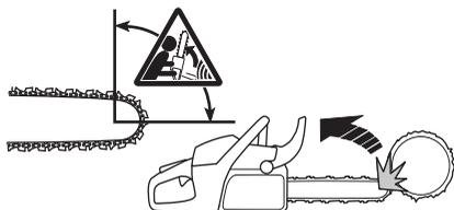
El corte con la parte inferior de la espada, en sentido descendente desde la parte superior del objeto a cortar, se denomina de corte con cadena tirante. La motosierra es tirada hacia el árbol y el canto delantero del cuerpo se apoya contra el tronco. Con esta técnica de cadena tirante, el usuario controla mejor la motosierra y la situación del sector de riesgo de reculada de la espada.
